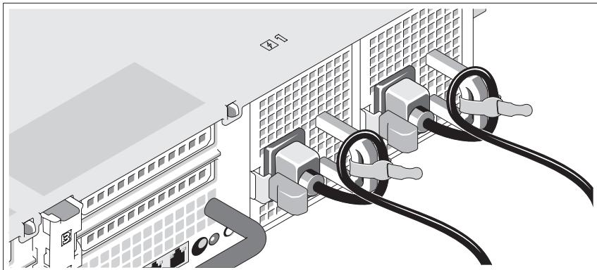
Doble los cables de alimentación del sistema en forma de bucle, como se muestra en la ilustración, y fíjelos al soporte con la correa proporcionada.
